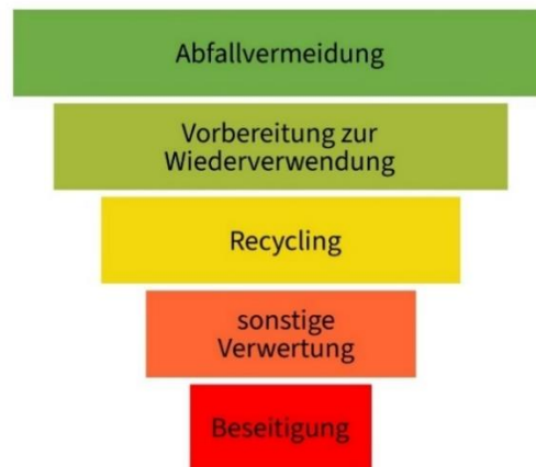
Abb. 4: Abfallhierarchie gemäß des Kreislaufwirtschaftsgesetzes. Die Abfallvermeidung genießt hierbei die höchste Priorität. Die Reduktion des Materialeinsatzes ist eine mögliche Strategie zur Abfallvermeidung [16].
