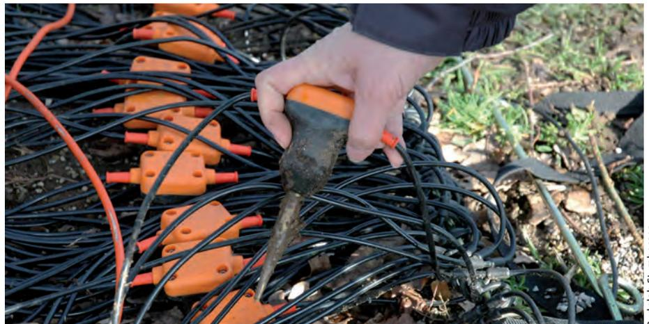
Im Boden steckende Geophone registrieren die Schwingungen in der Tiefe und leiten diesen an einen zentralen Messwagen weiter.
