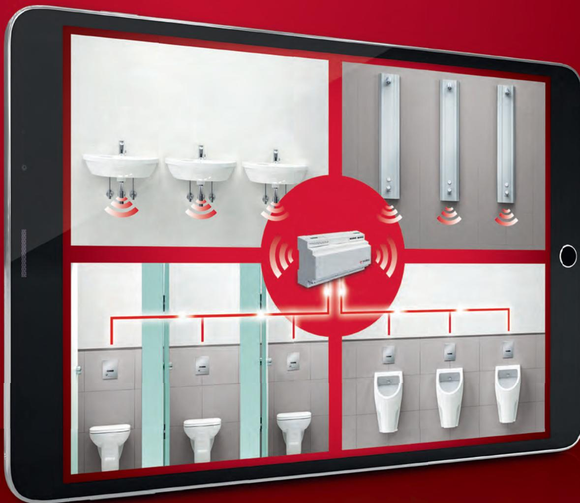
Das intelligente eSCHELL Wassermanagement-System ist die Antwort auf die gestiegenen Hygiene-Anforderungen und ein modernes Facility-Management in öffentlichen Sanitärräumen. Denn mit eSCHELL lassen sich Armaturen jetzt denkbar einfach via Funk oder Kabel vernetzen.
