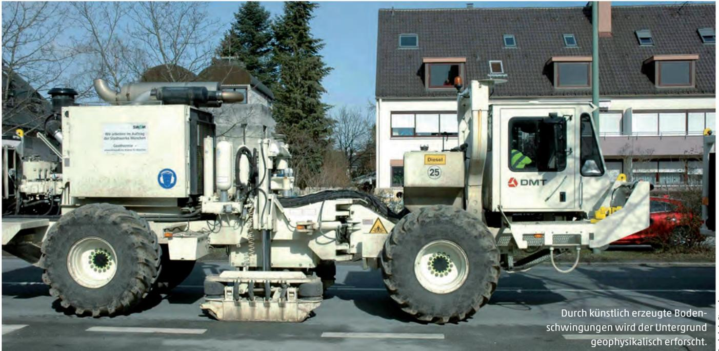
Durch künstlich erzeugte Bodenschwingungen wird der Untergrund geophysikalisch erforscht.
