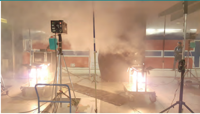
Abb. 3: Für den Versuch wurden computergesteuerte Propangasbrenner am Bahnsteig gezündet und zusätzlich Nebelmaschinen gestartet.
