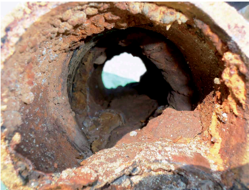
Inkrustation und Sedimentation in Wasserrohrleitungen aus Gusseisen DN 100
