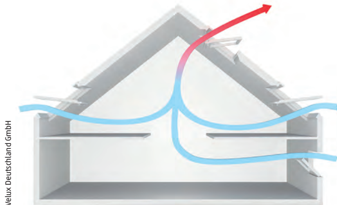
Der Kamineffekt macht sich die Eigenschaft warmer Luft zu Nutze, nach oben zu steigen und ermöglicht so besonders effektives Lüften. Während warme und verbrauchte Luft nach oben steigt und durch die Dachfenster abgeführt wird, strömt von unten durch die Fassadenfenster im Erdgeschoss kühle, frische Luft nach.
