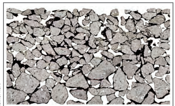
Abb. 2: Großdünnschliff einer offenporigen Deckschicht
