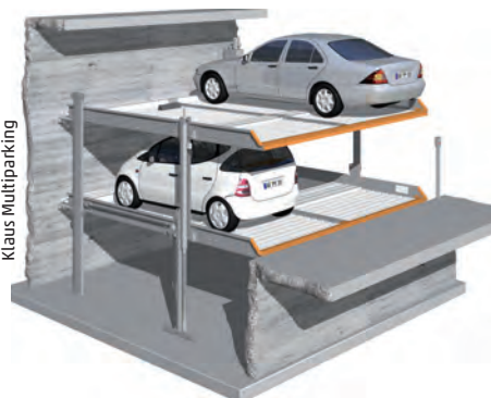
3D-Zeichnung der neuen MultiBase 2072i von Klaus Multiparking als Doppelbühne
