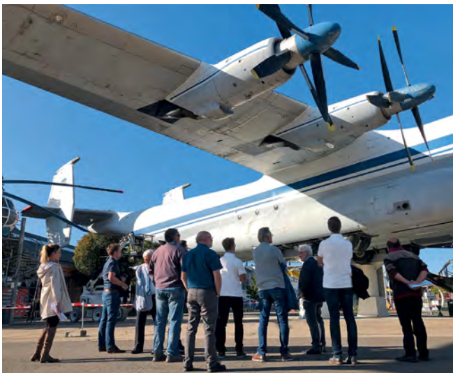
Die Teilnehmer vor dem riesigen Antonov An-22 Großraumflugzeug im Speyerer Technik Museum. Mit einer Spannweite von 64 Metern und einem Leergewicht von 114 Tonnen gehört die An-22 zu den größten Propeller-Flugzeugen der Welt.
