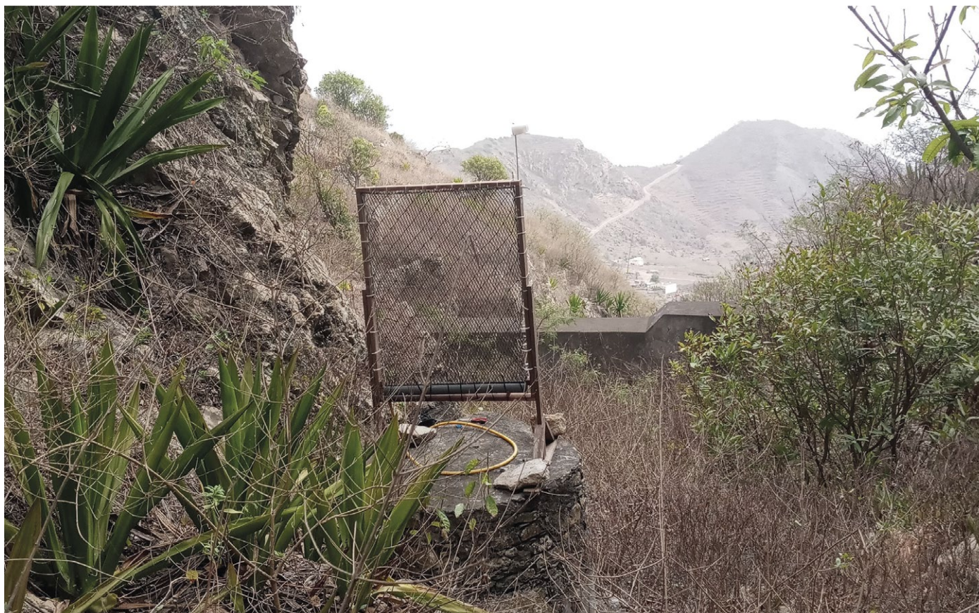
Der Prototyp eines Nebelnetzes zur Wassergewinnung wird getestet
